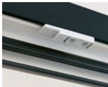
KONTAKTRON magnetyczny czujnik otwarcia okna i drzwi, jest częścią systemu kontroli dostępu Smart Home lub systemu alarmowego
