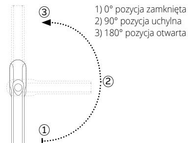
OKUCIE TBT (TILT BEFORE TURN) uchyl przed otwarciem - zabezpieczenie kluczykiem przed pełnym otwarciem okna
