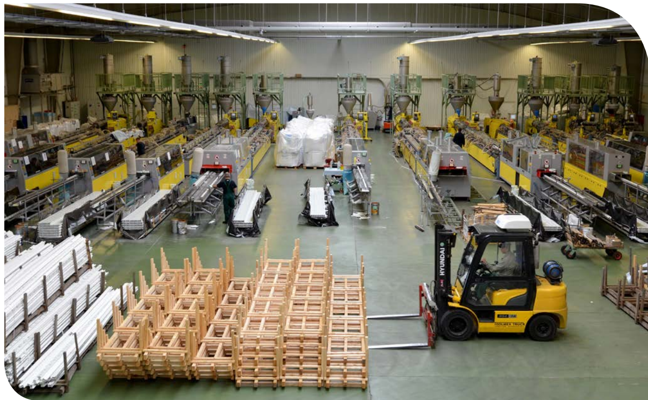
Extrusion des profilés PVC
