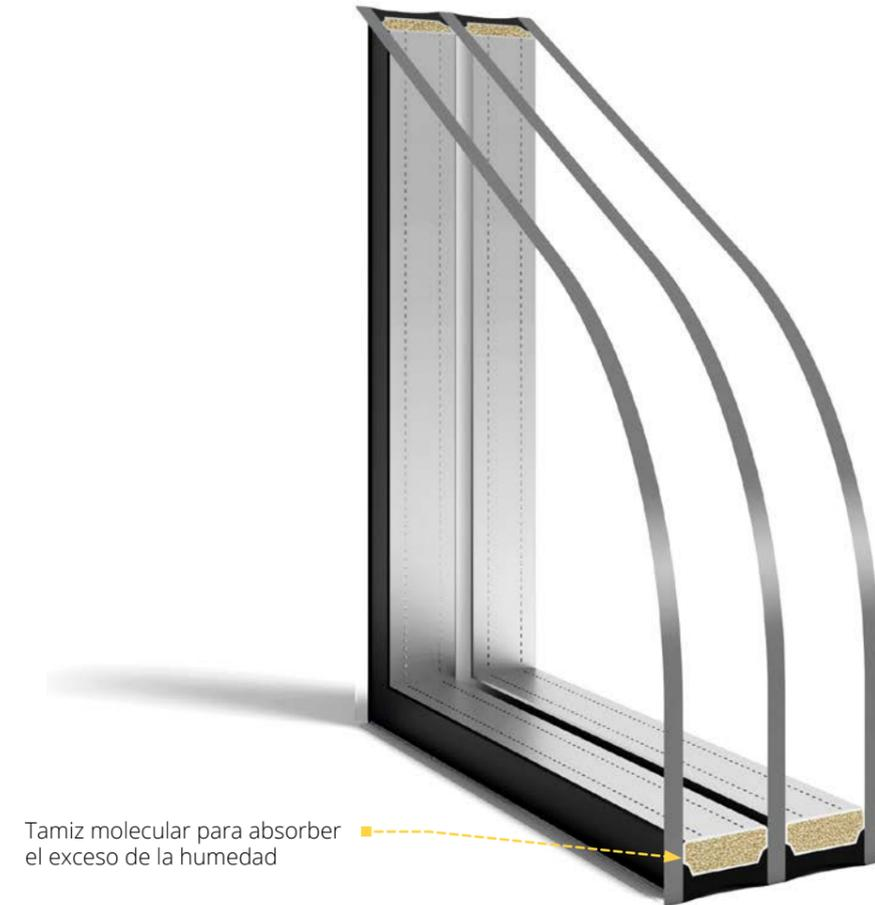
Tamiz molecular para absorber el exceso de la humedad
